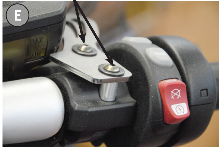
Viti TB + rondella piana Inbusschrauben + flache Unterlegscheibe Allen screws + flat washers
