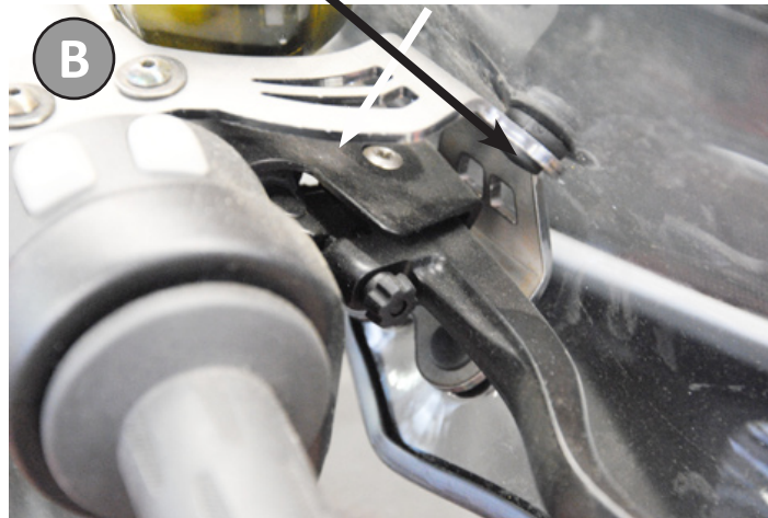
Viti TB + rondella piana Inbusschrauben + flache Unterlegscheibe Allen screws + flat washers
