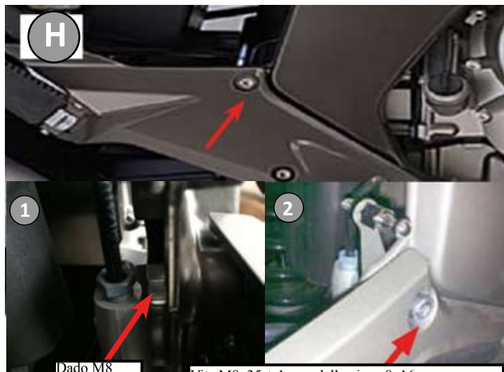
I Vite M8x35 + 1x rondelle plane 8x16, Schraube M8x35 + 1x flache Unterlegscheibe 8x16 Bolt M8x35 + 1x flat washer 8x16
