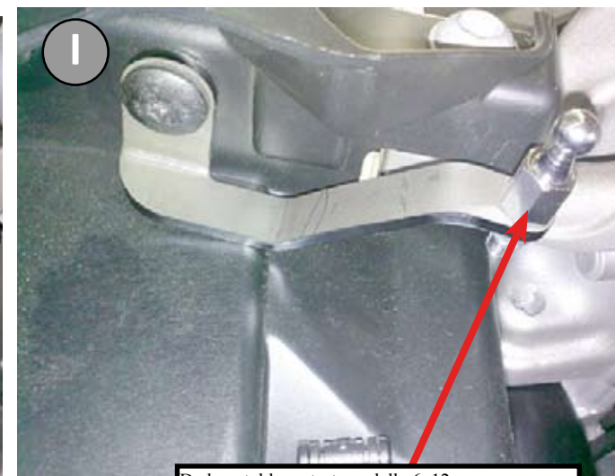
J Dado autobloccante + rondella 6x12 Selbstsichernde Mutter + Unterlegscheibe 6x12 Self-locking nut + washer 6x12
