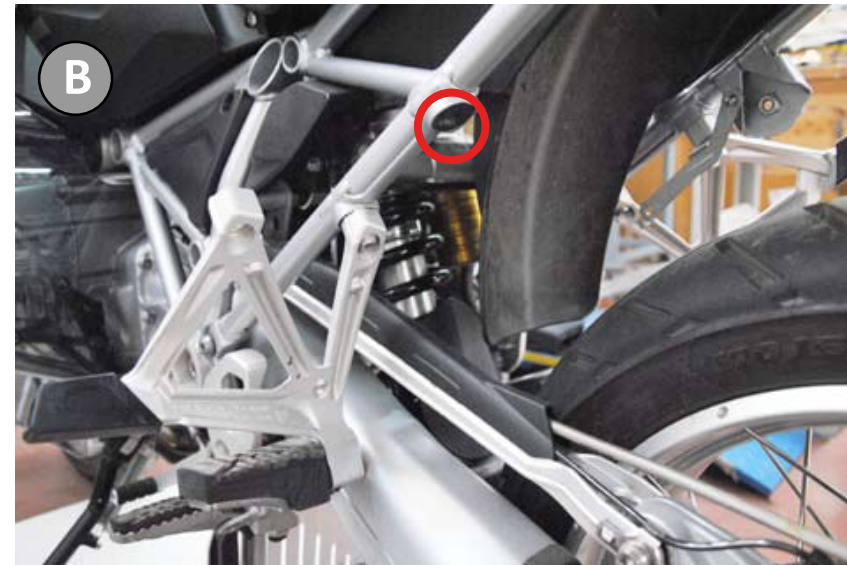
esterno: viti M6x20 Außen: Schraube M6x20 Outside: M6x20 screw
