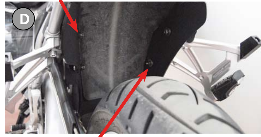
Interno: dadi M6 + rondelle Innen: M6 Muttern + U-Scheibe Inside: M6 nut + washer
